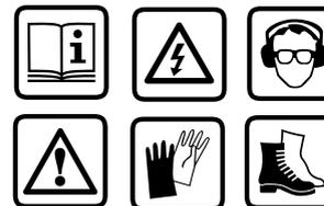
**ВНИМАНИЕ!** Перед монтажом шины направляющей и цепи пильной отключите цепную пилу от электропитания. Обязательно отсоедините вилку кабеля электропитания цепной пилы от розетки удлинительного кабеля. Во избежание травм все действия с цепью пильной выполняйте в защитных рукавицах.
