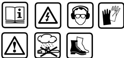
**ВНИМАНИЕ!** Перед сборкой, регулировкой или проверкой цепной пилы необходимо надеть спецодежду и защитные средства. Будьте предельно внимательны и осторожны. Перед монтажом шины направляющей и цепи пильной отключите цепную пилу от электропитания. Обязательно отсоедините вилку кабеля электропитания
