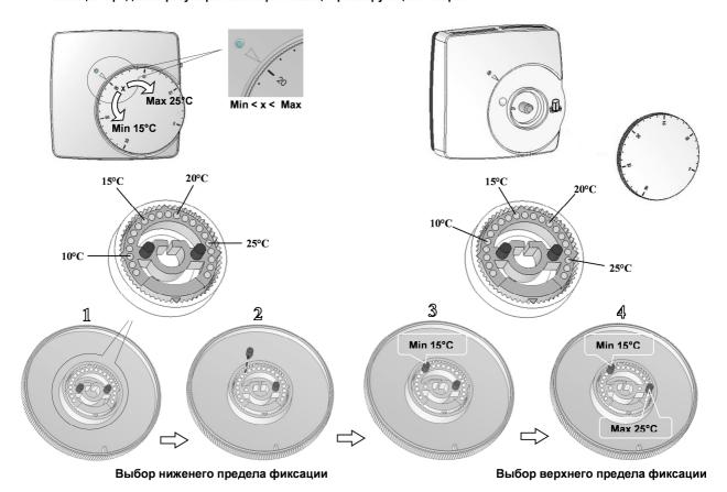
Калибровка термостата проводится минимум через 24 часа после монтажа
