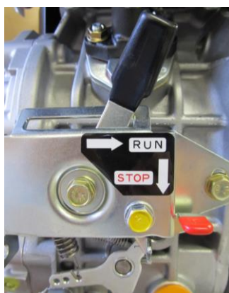
Ручка-переключатель «RUN-STOP» в положении «РАБОТА»
