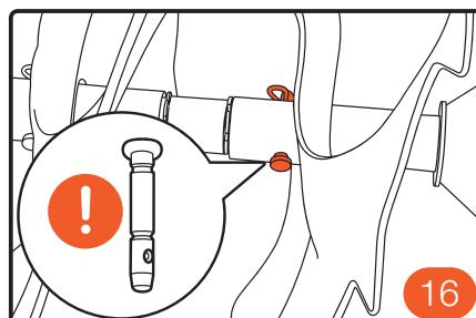
**Примечание:** Шнек крепится на валу при помощи штифтов безопасности (рис. 16). Они разрушаются при попадании в шинки твердых предметов или при перегрузке. Используйте только оригинальные штифты.
