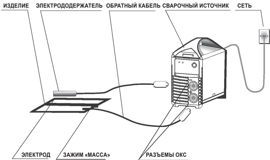
*Рисунок 5.1 Схема подключения оборудования для ММА сварки*
