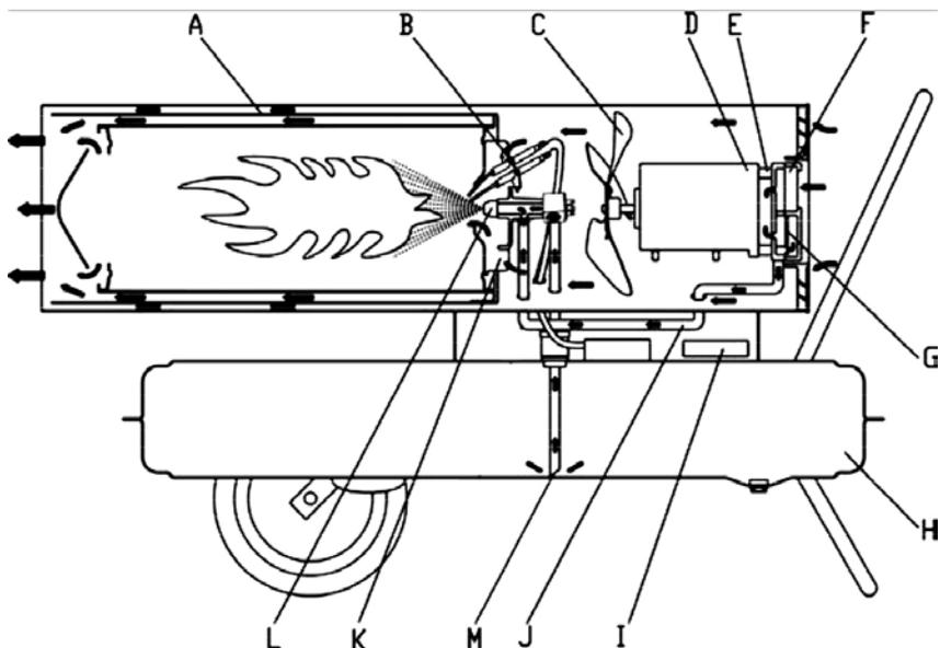
A. Камера сгорания В. Свеча зажигания С. Лопасть вентилятора D. Двигатель E. Насос(Компрессор) F. Впускной воздушный фильтр G. Выпускной воздушный фильтр H. Топливный бак I. Детектор J. Воздухоподводящая труба K. Огнеупорная пластина L. Топливная форсунка M. Трубка для нагнетания топлива.
