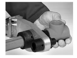
После того как труба и втулка нагреются до необходимой температуры их нужно быстро снять с аппарата и вставить друг в друга.
