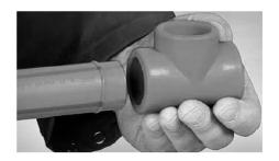
После соединения нужно быстро выставить углы и направления стыка и зафиксировать на 30...40 сек для гарантированной полимеризации шва.
