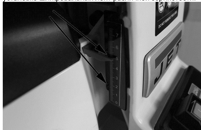
Рис. 8-1: настройка шкалы глубины
