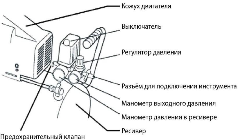
установленной границы, автоматика включит двигатель для восполнения использованного воздуха.
