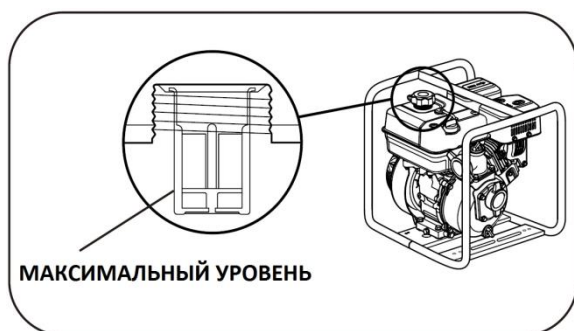
Рисунок 5. Максимальный уровень заполнения топливного бака.
