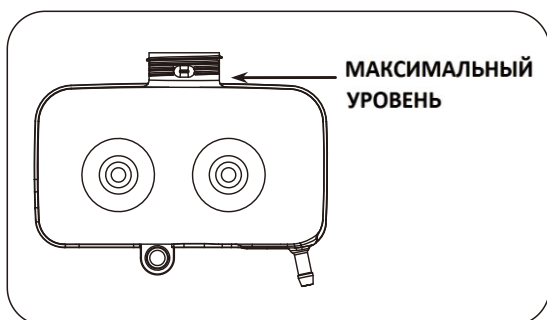
Рисунок 5. Максимальный уровень заполнения топливного бака.
