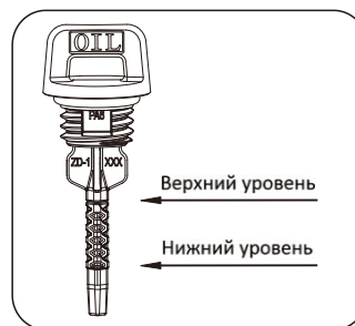
Рисунок 3. Отметки на масляном щупе.
