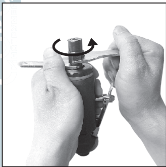
Рисунок 3 – Ослабление цангового зажима
