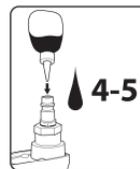
Для смазывания устройства применяйте масло для пневмоинструмента с вязкостью ISO VG-32 и автоматическую масленку воздушной магистрали, настроенную на подачу 2 капли в минуту. Если применение автоматической воздушной магистрали невозможно, то вводите 4-5 капель масла для пневматического инструмента в отверстие впускного патрубка перед
