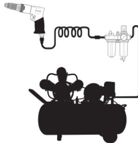
Все управляющие элементы, соединительные линии и шланги должны быть рассчитаны на необходимое давление и объемный расход воздуха. Не допускайте сужения подводных линий, например, в результате пережатия, перегибов или растягивания. Перед подключением шланга к инструменту периодически продувайте шланг мощным напором воздуха для удаления влаги из шланга.
