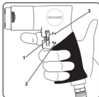
Überprüfen Sie die eingestellte Drehrichtung. Zum Festziehen von Schrauben und Muttern drücken Sie die Regulierverschraubung in Richtung F durch (Forward / Rechtslauf). Zum Lösen von Schrauben und Muttern drücken Sie die Regulierverschraubung in Richtung R durch (Reverse/ Linkslauf). Überprüfen Sie die Position des Drehmomentreglers: Beim
