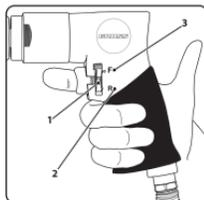
Проверьте установленное направление вращения. Для закручивания винтов установите переключатель направления вращения (1) в направлении F (3) (Forward/вперед). Для откручивания винтов установите переключатель в направлении R (2) (Reverse/назад).
