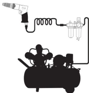
Sämtliche Steuerelemente, Verbindungsleitungen und -schläuche müssen für den Solldruck und Luftvolumenstrom ausgelegt sein. Vermeiden Sie die Verengung der Zuführungsleitungen, z.B. durch abgequetschte, geknickte bzw. ausgedehnte Stellen. Vor dem Anschluss des Schlauches an den Werkzeug blasen Sie den Schlauch regelmäßig aus, um Reste der Feuchtigkeit aus dem Schlauch zu entfernen.
