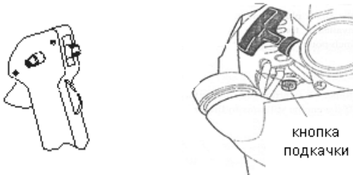
Рис. 8. Акселератор и праймер для подкачки топлива
