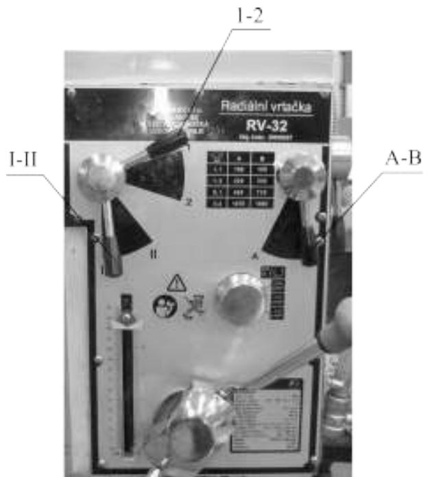
При помощи ручек переключения оборотов шпинделя(1-2; I-II; A-B. рис.8) можно установить восемь ступеней выходных оборотов шпинделя (см. таблицу 1). Для того чтобы изменить скорость вращения шпинделя, прежде всего, остановите двигатель. Установите ручку переключения в требуемое положение, при затруднении включения нажмите кнопку «Т» (3 рис.6) произойдет проворот шестерен и они войдут в зацепление.
