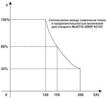
Если сварочный аппарат перегрева, сработает защита БТИЗ от перегрева, на передней панели загорится сигнальная лампа перегрева. Следует оставить аппарат на 15 минут, чтобы вентилятор его охладил. При возобновлении работы необходимо уменьшить сварочный ток или продолжительность включения.
