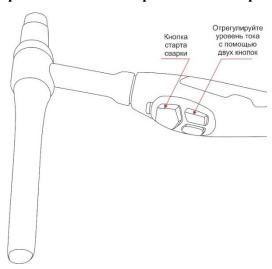
В случае применения аргонодуговой горелки с кнопками настройки режимов сварки: нажатие на кнопку «+» увеличивает рабочее значение сварочного тока, нажатие на кнопку «-» уменьшает рабочее значение сварочного тока.
