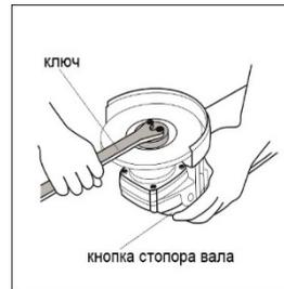
3. Теперь накрутите на шпindelь наружный фланец с внутренней резьбой, при этом обратите внимание на то, какой стороной его надевать, это зависит от типа применяемого диска. Шлифовальный диск необходимо зажимать той стороной наружного фланца, на которой имеется кольцевой выступ, входящий в внутреннее отверстие диска. Отрезной диск необходимо зажимать плоской стороной наружного фланца (Рис.4).
