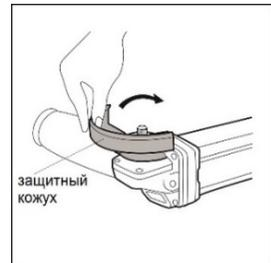
Затем проверните кожух на 180° по часовой стрелке (Рис.3) затяните винт защитного кожуха
