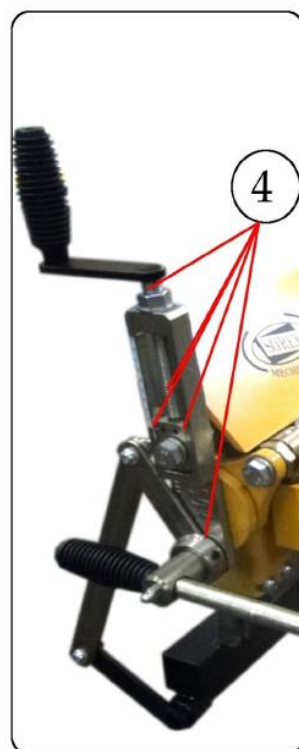
Смазывание подвижных точек механизма поднятия нажимной балки - типа загибание листа с четырёх сторон (маслёнка)
