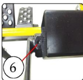
Смазывание подвижных точек ногого механизма поднятия нажимной балки (маслёнка)
