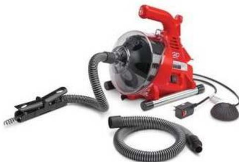
Модель PowerClear™ оснащена электродвигателем мощностью 120 Вт, поддерживающим скорость вращения до 450 об/мин. Износостойкая спираль MAXCORE™ 50 толщиной 6 мм и длиной 9 м имеет центральный стержень, который обеспечивает повышенную жёсткость спирали и долгий срок её службы, а также предотвращает запутывание и попадание мусора внутрь витков.
