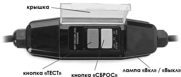
Полирователь **MESSER M3017** оснащен устройством PRCD. Всегда используйте PRCD в работе для снижения риска поражения электрическим током. Располагайте PRCD как можно ближе к источнику питания. Проводите тестирование PRCD перед каждым использованием. Нажмите кнопку **«ТЕСТ»** для проверки. Нажмите кнопку **«RESET»**, чтобы включить защитное устройство.
