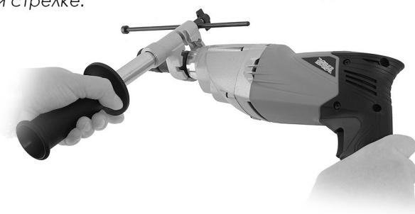
**ВНИМАНИЕ:** Прежде чем дать нагрузку на метчик, убедитесь, что диаметр отверстия для нарезания резьбы соответствует требованиям (см.таблицу в конце инструкции). Отверстие несоответствующего диаметра может вызвать заклинивание метчика или создать травмоопасную ситуацию.
