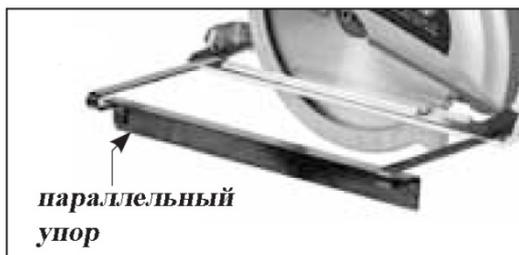
Используйте параллельный упор при линейной распиловке.
