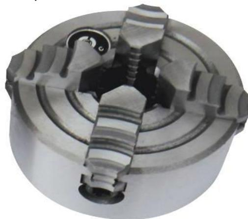
Рис 7-6: Четырехкулачковый патрон с независимым перемещением кулачков
