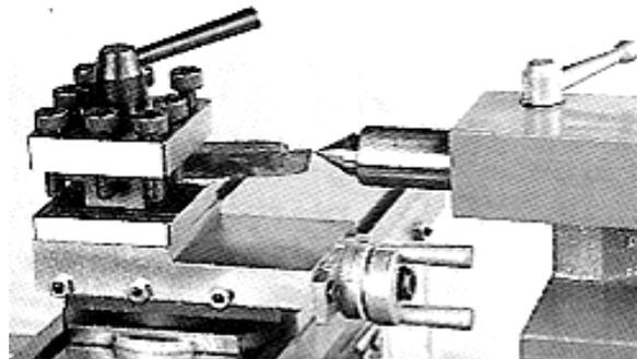
Рис 8-5: Крепление резца
