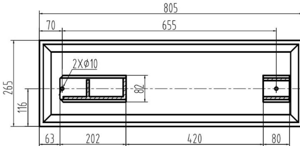
Рисунок 5-2: Схема расположения болтов крепления станины токарного станка
