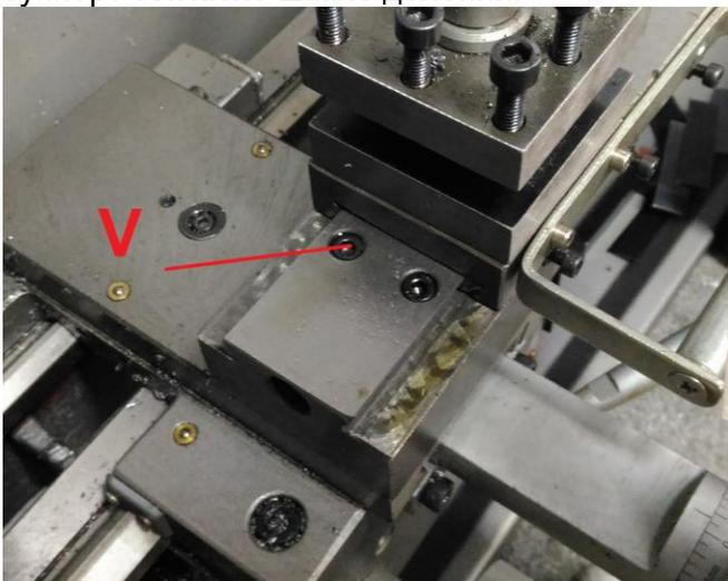
Рис 7-4: Точение конуса с помощью верхнего суппорта
