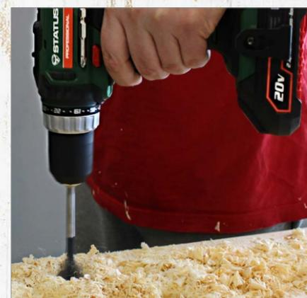
направляющих отверстий 3 мм на глубину 40 мм, «глухари» 8×120 мм и 10×120 мм. Далее, решили пустить в дело «глухарь» 10×160 мм. Нагрузка ощущалась довольно сильная. При этом система защиты от перегрузки кратковременно давала о себе знать, но всё-таки полностью силы оставили CSL12-2Li, не докрутив крепёж 55 мм до плоскости дерева. Старший шуруповёрт – CTR20-2Li – не дотянул до финиша всего 25 мм.
