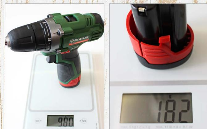
Разница в габаритах существенная. Можно сказать, что данные инструменты – антиподы. Компактный CSL12-2Li блестяще справляется с «ролью Давида». При серьёзных возможностях этот 12-вольтовый шуруповёрт легко умещается на листе бумаги формата А4 с заметным запасом по высоте. Весит модель тоже немного. По факту, с батареей получилось всего 980 гр. Вес аккумуляторной батареи отдельно – 182 гр. Даже пластиковый кейс занимает минимум пространства, так как комплектующие в нём упакованы плотно.
