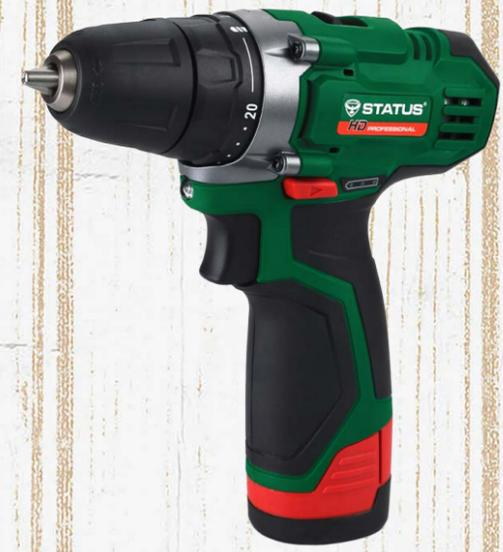
У CSL12-2Li имеется одномуфтовый быстрозажимной патрон диаметром 10 мм, блокировка вала, мгновенный электронный тормоз двигателя и подсветка рабочей зоны, расположенная над курком. Благодаря специальной линзе, направленной под углом немного вверх, даёт направленный световой пучок на рубеже рабочей зоны, что весьма практично, т.к. практически не создаёт тени от патрона. Муфта регулировки крутящего момента имеет 20 положений, регулирующих момент, плюс режим сверления.
