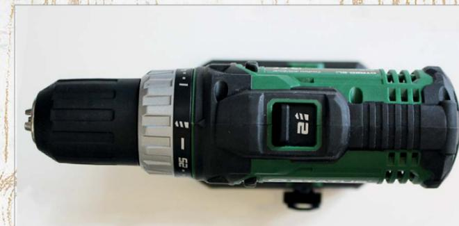
Результаты: CSL12-2Li – 9,9 сек., CTR20-2Li – 9,2 сек. Закручивали мы на пониженной скорости. Она у обоих инструментов одинаковая – 400 об./мин. Разница во времени произошла из-за того, что у младшего шуруповёрта три раза кратковременно срабатывала защита, которая так же быстро восстанавливалась. Частота вращения на высоких оборотах у 12 V и 20 V моделей составляет 1300 и 1400 об./мин., соответственно.
