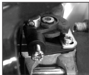
Рис. 16 Винт настройки оборотов холостого хода
