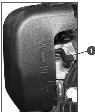
Рис. 9 Расположение воздушной заслонки
