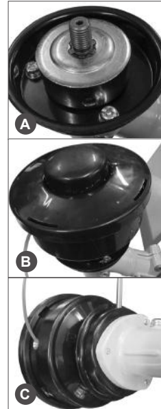
Рис. 6 Установка триммерной головки
