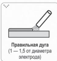
Очень важно, чтобы длина дуги была правильной, т.к. это влияет на сварочный ток и напряжение. Непрочный сварочный шов является результатом неправильного тока сварки. Наклон
