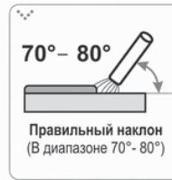
электрода (вперед) должен составлять  $70^\circ$  или  $80^\circ$ . При слишком большом наклоне сварочный шов может стать пористым.
