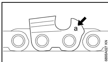
Обозначение (а) шага цепи выгравировано в области ограничителя глубины каждого режущего зуба.
