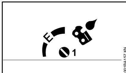
Подача смазочного масла может регулироваться в зависимости от потребности с помощью регулировочного винта (1).
