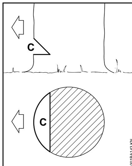
Подпил (С) определяет направление валки дерева.
