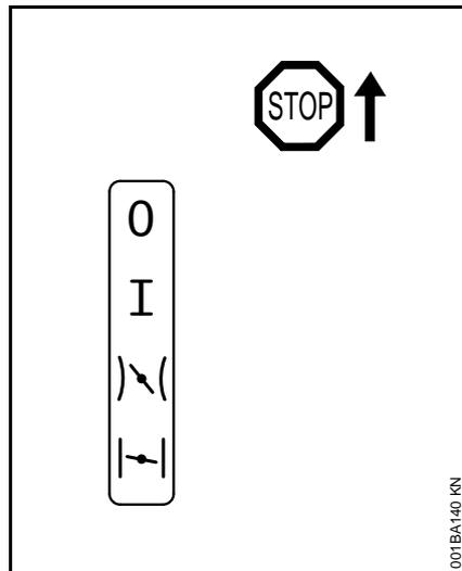
**Stop 0** – мотор остановлен – зажигание выключено
