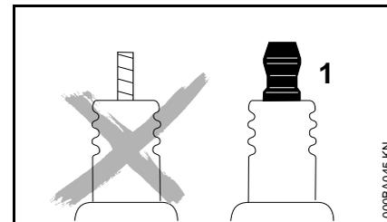
У свечи зажигания с отдельной соединительной гайкой
