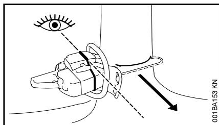
Выбранное направление валки дерева при проведении подпила может контролироваться с помощью валовой планки на кожухе, а также на корпусе вентилятора мотопилы.
