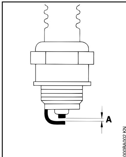
При недостаточной мощности двигателя, при плохом запуске или перебоях на холостом ходу в первую очередь следует проверить свечу зажигания.
