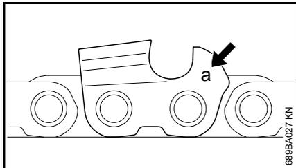
Обозначение (а) шага цепи выгравировано в области ограничителя глубины каждого режущего зубца.
