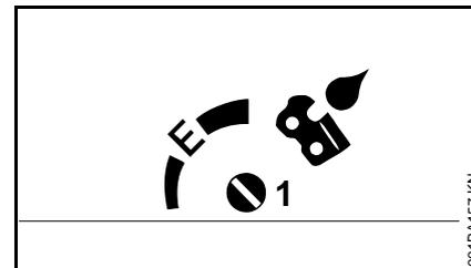
С помощью регулировочного винта (1) (на нижней стороне машины) может регулироваться кол-во подачи масла в зависимости от потребности.
