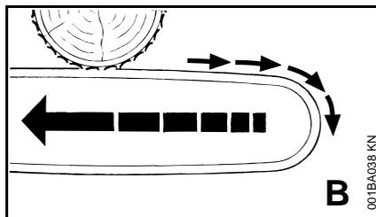
Если при пилении верхней стороной направляющей шины – обратный пропилов – цепь пилы защемляется или наталкивается на твердый предмет в древесине, то пила может быть отброшена в сторону пользователя – **во избежание этого:**
