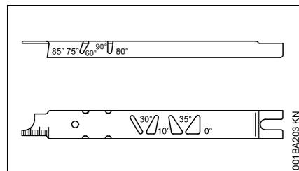
Опиловочный шаблон STIHL (специальные принадлежности, см. таблицу "Инструменты для заточки") – универсальный инструмент для контроля угла заточки и переднего угла, высоты ограничителя глубины,
