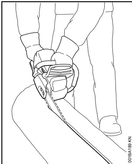
Техника работы без использования зубчатого упора – опасность втягивания – направляющую шину устанавливайте под возможно плоским углом – работайте особенно осторожно, – **опасность обратного удара!**
