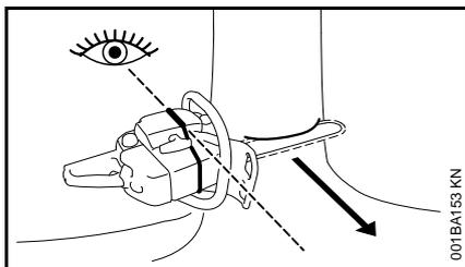
Выбранное направление валки дерева при проведении подпила может контролироваться с помощью валовой планки на коже, а также на корпусе вентилятора мотопилы.
