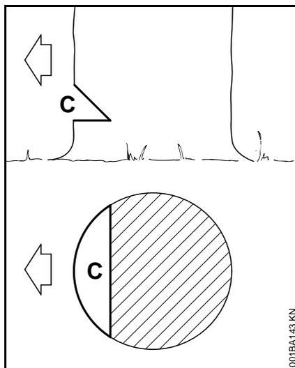
Подпил (С) определяет направление валки дерева.
