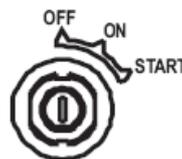
Поверните ключ стартера (Q1) до упора по часовой стрелке как только двигатель запустится.
