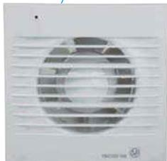
Модель оснащена регулируемым таймером (1-30 мин.). Вентилятор подключается через независимый выключатель или выключатель света. При включении света вентилятор начинает работать, после выключения света вентилятор продолжает работать согласно времени, заданному на таймере, по прошествии которого автоматически выключается.
