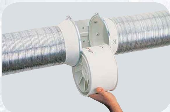
Уникальная конструкция вентилятора позволяет извлекать блок двигатель-крыльчатка без демонтажа воздуховодов, что делает обслуживание вентилятора легким и быстрым
