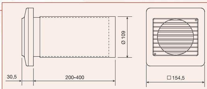
Комплект для настенного монтажа предназначен для организации выброса воздуха от вентиляторов EDM-80N, EDM-100, DECOR-100 и SILENT-100 непосредственно на улицу. В комплект входит наружная настенная решетка и телескопический пластиковый воздуховод. Комплект позволяет устанавливать вентиляторы на стену толщиной от 20 до 42 мм.
