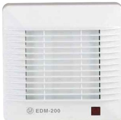
Вентиляторы EDM-200 изготавливаются из высококачественного пластика, комплектуются световым индикатором работы и однофазным электродвигателем (230В-50Гц), класс изоляции В, со встроенной термозащитой. Модель "Z" оснащается электродвигателями с повышенным сроком службы, укомплектованными шариковыми подшипниками.
