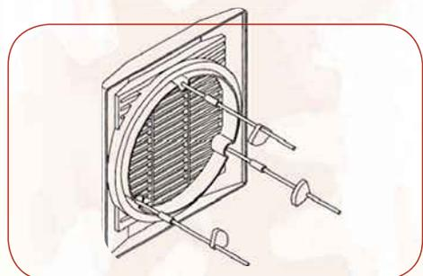
Удлинитель резьбовой шпильки используется для установки вентиляторов серии HV-STYLVENT на стену толщиной от 25 до 300 мм.
