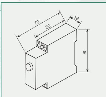
Таймер используется в системах автоматики приточных установок с электрическими воздушонагревателями для реализации функции охлаждения ТЭНов. Таймер позволяет вентилятору работать некоторое время после выключения системы.
