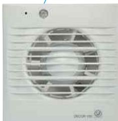
Модель оснащена инфракрасным датчиком движения и регулируемым таймером (1-30 мин.). Вентилятор включается автоматически, когда датчик фиксирует движение в радиусе 4 м от вентилятора и выключается по прошествии времени, заданного на таймере.
