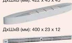
Саморегулирующиеся приточные клапаны с расходом воздуха 22, 30, 36 и 45 м<sup>3</sup>/ч изготавливаются из литого полистирола и предназначены для установки на оконных рамах. С внутренней стороны помещения на клапане располагается шумопоглощающая вставка.
