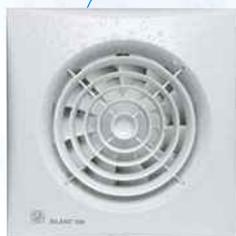
Модель оснащена гигростатом (датчиком влажности) и регулируемым таймером (1-30 мин.). Гигростат можно настроить на уровень относительной влажности от 60% до 90%. В автоматическом режиме вентилятор работает согласно показаниям гигростата: включается при повышении уровня влажности в помещении выше заданного значения и выключается при его понижении и по прошествии времени, заданного на таймере.
