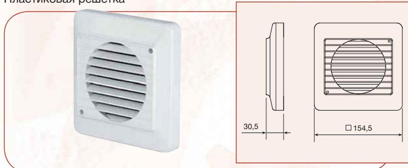
Пластиковая решетка GR-100 предназначены для непосредственного подсоединения к воздуховоду диаметром 100 мм и может устанавливаться внутри или снаружи помещения.
