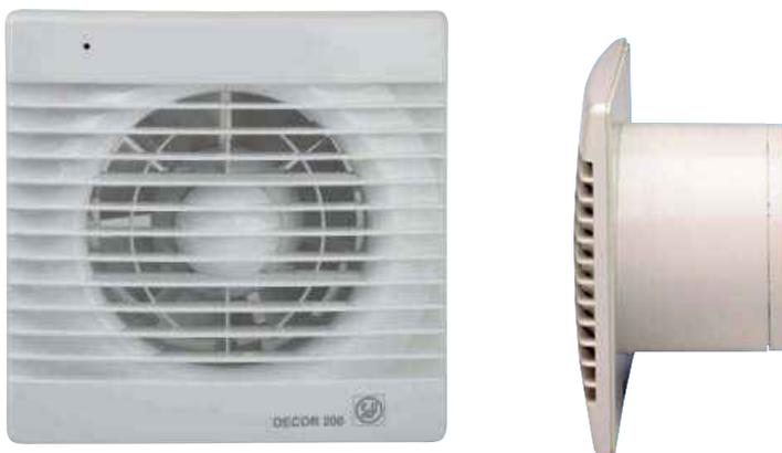
Вентиляторы DECOR-200 изготавливаются из высококачественного пластика, комплектуются световым индикатором работы и однофазным электродвигателем (230В-50Гц), класс изоляции В, со встроенной термозащитой. Модель "Z" оснащается электродвигателями с повышенным сроком службы, укомплектованными шариковыми подшипниками.
