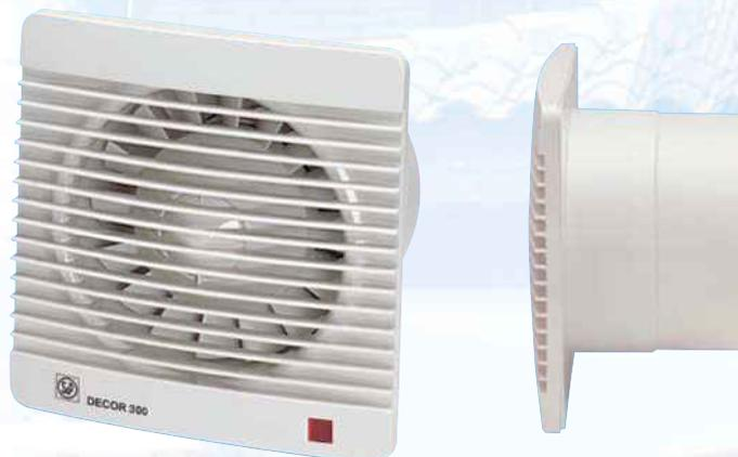
Вентиляторы DECOR-300 изготавливаются из высококачественного пластика, комплектуются световым индикатором работы и однофазным электродвигателем (230В-50Гц), класс изоляции В, со встроенной термозащитой. Модель "Z" оснащается электродвигателями с повышенным сроком службы, укомплектованными шариковыми подшипниками.
