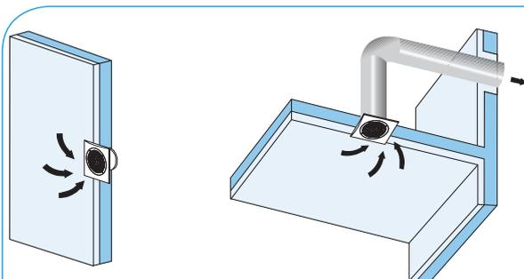
Настенная или потолочная установка с выбросом воздуха на улицу или через систему воздуховодов
