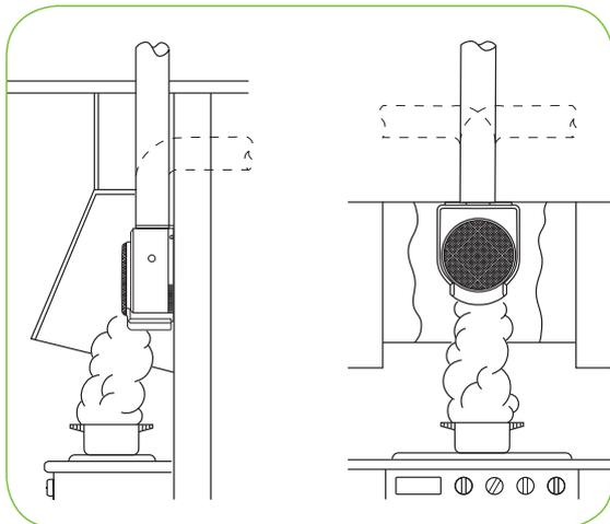
Для наибольшей эффективности удаления загрязненного воздуха, кухонные вытяжные вентиляторы необходимо устанавливать над плитой, внутри кухонного зонта. При этом зонт может быть выполнен из металла, дерева или других подходящих материалов.
