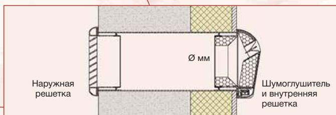
Саморегулирующиеся приточные клапаны предназначены для настенной установки, укомплектованы наружной решеткой, внутренней решеткой с шумоглушителем и круглым металлическим воздуховодом диаметром 125 мм.
