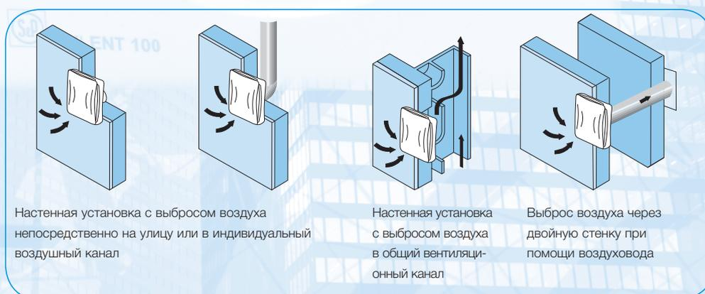
Настенная установка с выбросом воздуха непосредственно на улицу или в индивидуальный воздушный канал
