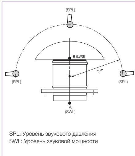
Для получения уровней звуковой мощности в точках А или В, в режиме вытяжки, необходимо, к уровням звукового давления, указанном в таблице с техническими характеристиками, прибавить поправочные коэффициенты, приведенные в следующей таблице:
