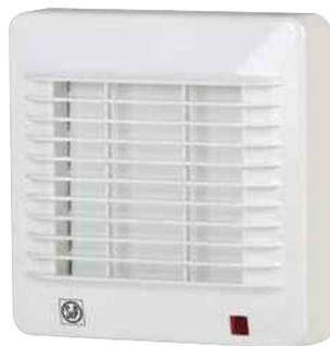
Вентиляторы EDM-100 изготавливаются из высококачественного пластика, комплектуются световым индикатором<sup>(1)</sup> работы и однофазным электродвигателем (230В-50Гц), класс изоляции В, со встроенной термозащитой. Модель "Z" оснащается электродвигателями с повышенным сроком службы, укомплектованными шариковыми подшипниками. Вентиляторы имеют II класс герметичности<sup>(2)</sup>, класс защиты IP 44<sup>(3)</sup> и рабочую температуру воздуха от 0°C до +40°C.
