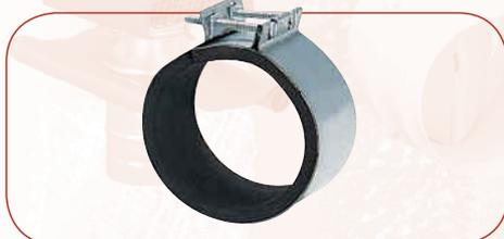
Быстроразъемные хомуты предназначены для присоединения круглых канальных вентиляторов к воздуховодам. Слой мягкого синтетического материала предотвращает передачу вибраций от вентилятора на воздуховод.
