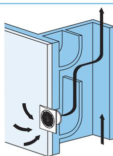
Настенная установка с выбросом воздуха в общий вентиляционный канал
