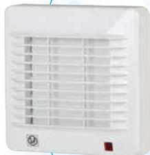
Модель оснащена регулируемым таймером. Вентилятор подключается через независимый выключатель или выключатель света. При включении света вентилятор начинает работать, после выключения света вентилятор продолжает работать согласно времени, заданному на таймере, по прошествии которого автоматически выключается.
