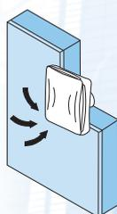
Настенная установка с выбросом воздуха непосредственно на улицу или в индивидуальный воздушный канал
