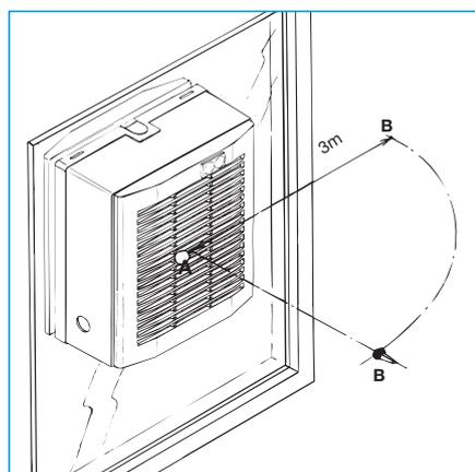
В таблице с техническими характеристиками приведены уровни звукового давления на расстоянии 3 м от вентилятора, в свободном пространстве (точка В на рис.)
