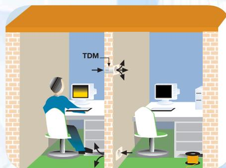
Модели 100 и 200 могут устанавливаться внутри стены, это удобное решение для вентиляции небольших помещений или распределения тепла между соседними помещениями.
