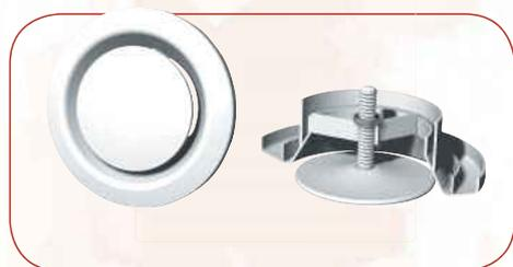
Белые пластиковые вытяжные диффузоры для применения в системах вентиляции, кондиционирования или отопления. При помощи вращения центральной части можно плавно отрегулировать расход воздуха.
