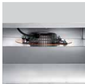
Искробезопасная конструкция Медные вставки исключают образование искр между подвижными и неподвижными частями вентилятора.
