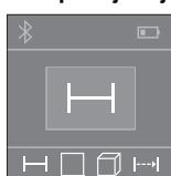
Nakon uključivanja mjerni alat se nalazi u funkciji mjerena dužina. Druge funkcije mjerena možete podešiti višekratnim pritiskom na tipku **2** (vidi »Funkcije mjerena«, stranica 191). Nakon potvrde funkcije mjerena pritiskom na tipku za mjerjenje **4** laserska zraka se uključuje.
