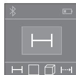
После включения измерительный инструмент находится в режиме измерения длины. Другие режимы измерения можно настроить многочтным нажатием на кнопку **2** (см. «Режимы измерений», стр. 72). После подтверждения режима измерения с помощью кнопки измерения **4** включается лазерный луч.
