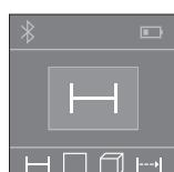
Pēc ieslēgšanas mērinstruments uzsāk darboties garuma mērišanas režīmā. Pāreja citos mērišanas režīmos notiek, atkārtoti nospiežot taustiņu **2** (skatīt sadāļu „Mērišanas veidi“ lappusē 218). Pēc izvēlētā mērišanas režīma apstiprināšanas, nospiežot mērišanas taustiņu **4**, ieslēdzas lāzera stars.
