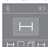
Після увімкнення вимірювальний інструмент знаходиться в режимі вимірювання довжини. Інші режими вимірювання можна налаштувати багаторазовим натисканням на кнопку **2** (див. «Вимірювальні функції», стор. 88). Після підтвердження режиму вимірювання кнопкою вимірювання **4** лазерний промінь вмикается.
