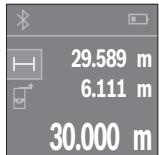
Нажмите на кнопку измерения **4** один раз для наводки на цель и еще раз для измерения.
