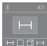
Po włączeniu urządzenie automatycznie ustawia się w funkcji pomiar długosci. Pozostałe funkcje pomiarowe można ustawić wciskając parokrotnie przycisk **2** (zob. »Funkcje pomiaru«, str. 13).
