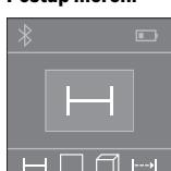
Po zapnutí se měřicí přístroj nachází ve funkci měření délky. Další měřicí funkce můžete nastavit vícenásobným stisknutím tlačítka **2** (viz „Měřicí funkce“, strana 27). Po potvrzení měřicí funkce tlačítkem měření **4** se zapne laserový paprsek.
