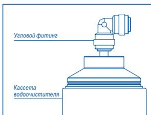
Установите корпус БАРЬЕР Минерализатор RO между тройником постфильтра и автопереключателем пластиковыми трубками. Для соединения пластиковой трубки с фитингом достаточно вставить трубку на 15–17 мм в фитинг.
