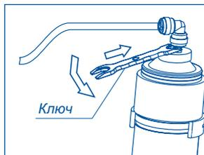
Для предотвращения растекания воды при демонтаже установите на пластиковые трубки фильтроэлемента транспортные заглушки. Придерживая водоочиститель, снимите отработанный фильтроэлемент с клипс. Запомните направление потока воды, указанное на наклейке фильтроэлемента.
