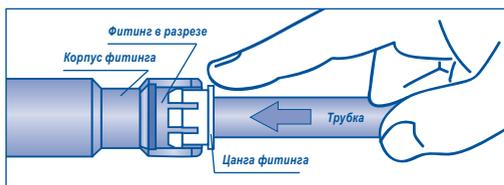
Как правило, при этом не требуется прилагать усилий. Если трубка не выходит из фитинга, не пытайтесь извлечь трубку, прилагая большие усилия. Это приведёт к поломке фитинга и/или разрыву трубки. Проконсультируйтесь со специалистом горячей линии БАРЬЕР.
