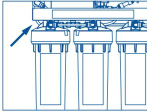
Поверните угловой фитинг вниз. Установите под фитинг вплотную к колбе ёмкость объёмом 4–5 литров. Медленно откройте вентиль на входе в водоочиститель приблизительно на треть поворота и промойте новые фильтроэлементы 3–4 литрами воды. Закройте вентиль, верните угловой фитинг в исходное положение и вставьте пластиковую трубку.
