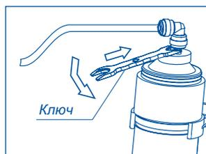
Распакуйте фильтроэлемент БАРЬЕР Минерализатор RO. Снимите транспортировочные колпачки. Наденьте угловые фитинги, идущие в комплекте, на трубчатые выступы фильтроэлемента.
