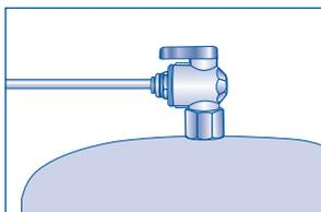
Откройте кран для чистой воды, чтобы сбросить давление, затем закройте кран.
