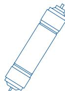
**6-я ступень — БАРЬЕР ПРОФИ Постфильтр.** Содержит уголь, обработанный серебром. Дополнительная очистка воды после накопительной ёмкости. Устранение неприятных запахов и привкусов.
