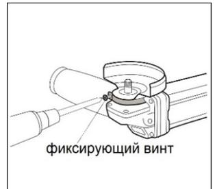
Кулачки кодирования гарантируют установку только подходящего к электроинструменту защитного кожуха.
