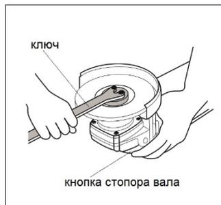
3. Теперь накрутите на шпindelю наружный фланец с внутренней резьбой, при этом обратите внимание на то, какой стороной его надевать, это зависит от типа применяемого диска. Шлифовальный диск необходимо зажимать той стороной наружного фланца, на которой имеется кольцевой выступ, входящий во внутреннее отверстие диска. Отрезной диск необходимо зажимать плоской стороной наружного фланца (Рис.4).
