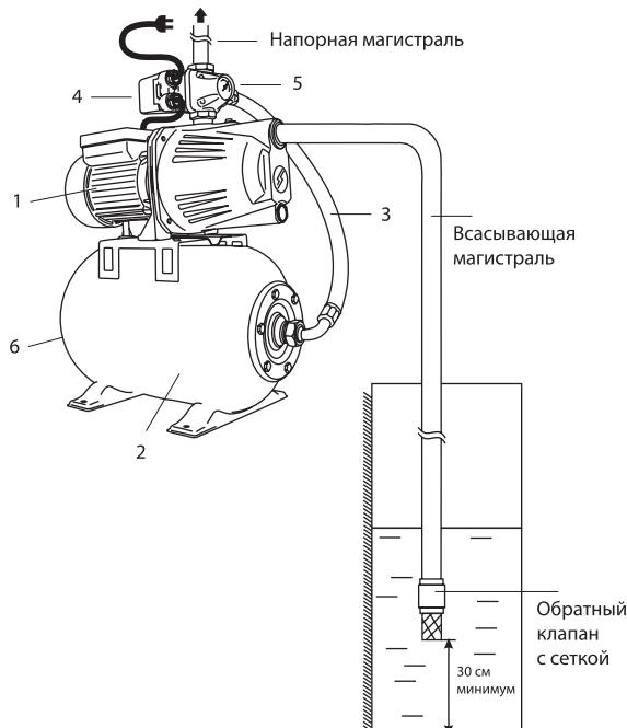
Станция состоит из насоса (1), гидроаккумулятора (2), соединительного шланга (3) и блока автоматики, состоящего из реле давления (4) и
