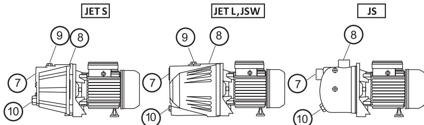
Насос имеет входное (7) и выходное (8) отверстия, а также заливное (9) и сливное (10) отверстия. У насосов серии JS залив воды осуществляется через выходное отверстие насоса (8). Принцип действия станции заключается
