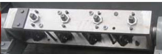
Рис.3 Опоры направляющей рамы, ролики, подшипники
