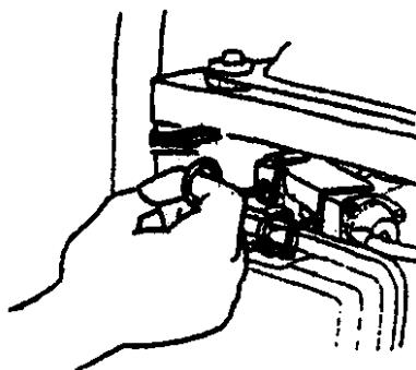
**Примечание:** Если двигатель запускается после короткого перерыва и он еще теплый, то рычаг должен оставаться в положении “**ОТКРЫТО**”.
