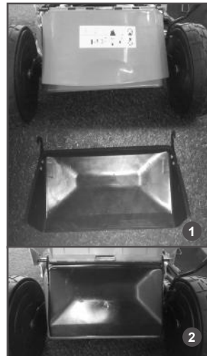
Рис. 4 Установка желоба заднего выброса
