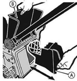
Рис. 3 Установка заглушки для мульчирования
