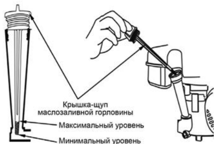
Рис. 7 Проверка уровня масла в картере
