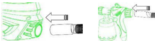
Рис.2. Подсоединение воздушного шланга
