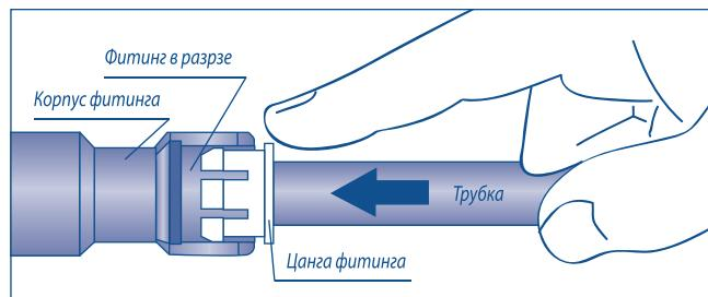
Как правило, при этом не требуется прилагать усилий. Если трубка не выходит из фитинга, не пытайтесь извлечь трубку, прилагая большие усилия. Это приведет к поломке фитинга и /или разрыву трубы. **Проконсультируйтесь со специалистом горячей линии БАРЬЕР.**
