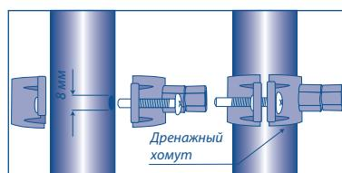
с уплотнением таким образом, чтобы отверстие в сливной трубе совпало с отверстием хомута. Установите вторую скобу и равномерно затяните крепежные болты так, чтобы две скобы располагались параллельно друг другу. Установите один конец ЧЕРНОЙ пластиковой трубы в фитинг дренажного хомута.
