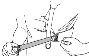
3 Отрегулируйте плечевой ремень так, чтобы нагрузка распределялась равномерно на
