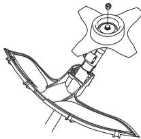
При сборке надо затягивать гайку против направления вращения режущего оборудования. При разборке надо отвинчивать гайку в
