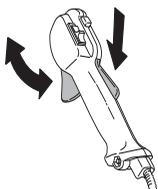
См. указания в разделе **Запуск**. Включите машину и полностью откройте дроссель. Отпустите рычаг дросселя и удостоверьтесь, что режущее оборудование останавливается и остается неподвижным. Если после постановки дросселя в положение холостого хода режущее оборудование продолжает вращаться, следует проверить регулировку холостого хода
