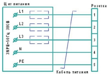
Рис. 3 Схема подключения розетки к стационарной сети
