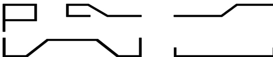
Рис. 5 Формы изгиба арматуры
