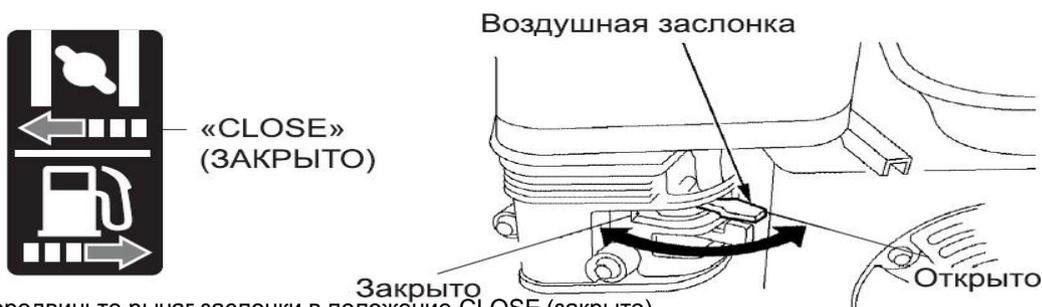
2. Передвиньте рычаг заслонки в положение CLOSE (закрыто).
