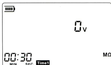
4. Нажмите и поверните по часовой стрелке кнопку PRESS TO TEST, чтобы выполнить тестирование изоляции по таймеру, при этом будет звучать звуковой сигнал, а на дисплее будет мигать знак **Time1**. На ЖК-дисплее появятся показания, подобные следующим:
