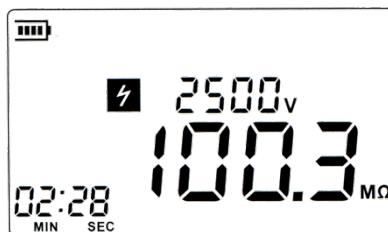
4. Отпустите кнопку, прибор автоматически отключится от высокого напряжения, при этом световой индикатор высокого напряжения выключится. Отсоедините провода щупа только тогда, когда на ЖК дисплее будут показания 0 V. На ЖК-дисплее будет отображена длительность тестирования и сопротивление изоляции (см. ниже).
