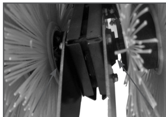
Рис. 4 Установка соединительных пластин крепления отвала
