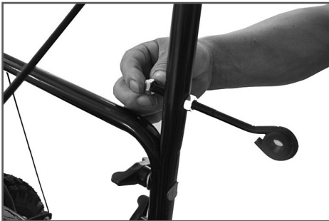
Рис. 13 Монтаж кронштейна рычага поворота желоба
