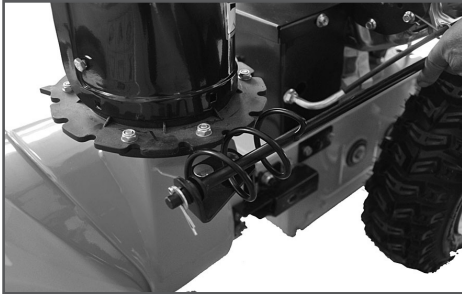
Рис. 12 Установка нижней части рычага поворота желоба
