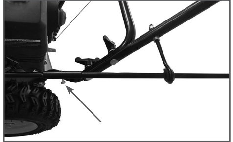
Рис. 14 Соединение верхней и нижней половины рычага поворота желоба
