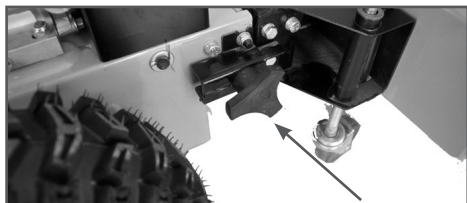
Рис. 7 Отсоединение щетки от корпуса машины
