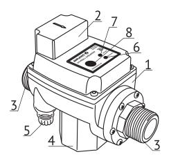
Блок управления ТУРБИ – М3 состоит из герметичного пластикового корпуса – (1) и верхней крышки с резиновой прокладкой – (2).
