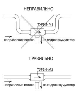
Для уплотнения соединений следует использовать тефлоновую ленту. Допускается как вертикальная, так и горизонтальная установка блока управления.
