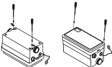
Для установки станции используйте поставляемые в комплекте пластины (F), привернув их вначале к корпусу станции, а затем к полу.
