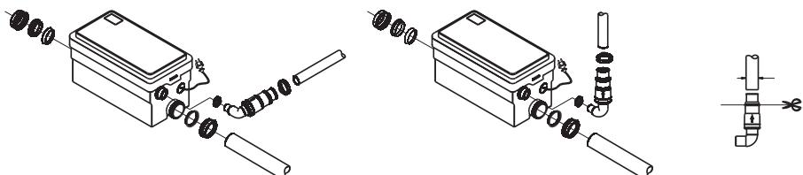
Для присоединения к боковым входам используйте уплотнительные кольца (D) и резьбовые гайки (B). Неиспользуемые входы закройте пробками-заглушками (C). Для присоединения к общей канализации используйте патрубок с обратным клапаном (A), закрепив его хомутами (E). Патрубок (A) должен быть установлен таким образом, чтобы стрелка на его
