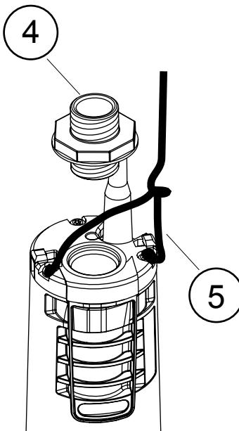
При необходимости удлинения электрокабеля используйте трехжильный влагостойкий кабель, типа H07 RNF, сечением не менее 1  $\text{mm}^2$ .
