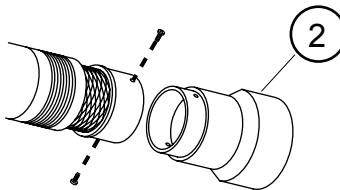
Если насос будет опущен на дно скважины или колодца, необходимо установить донное основание (2) при помощи двух крепежных винтов. Это защитит насос от всасывания грязи и песка.
