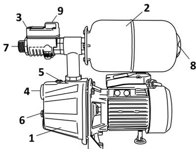
и сливное (6) отверстия. Напорная магистраль присоединяется к выходному патрубку блока управления (7). На корпусе гидроаккумулятора находится пневмоклапан (8) для регулировки давления сжатого воздуха. На верхней крышке блока управления расположен сигнальный светодиод (9), отображающий режимы работы устройства.
