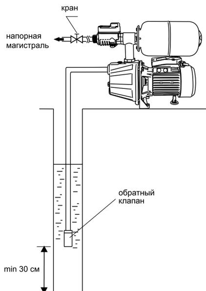
Станцию следует закрепить на жестком основании. Для уменьшения шума и вибрации при работе станции, ее крепление к основанию следует выполнять через резиновые шайбы и прокладки.
